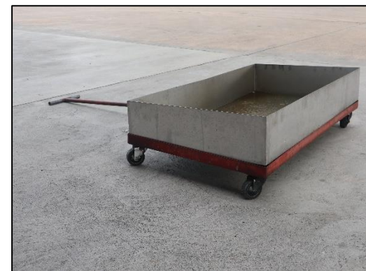
รูปที่ 2-4 การจัดเตรียมถาดเหล็กป้องกันการรั่วไหลไว้ใน พื้นที่โครงการ
